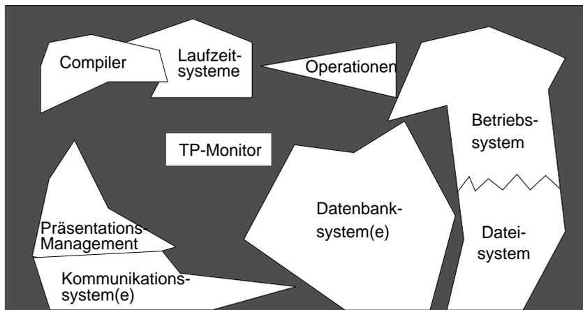
Der TP-Monitor integriert verschiedenartige Systemkomponenten, um eine gleichförmige Schnittstelle für Anwendungen und Operationen mit demselben Verhalten im Fehlerfall (*failure semantics*) zu bieten.
